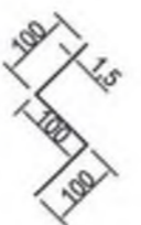
Tấm phân ly VL: INOX-304. DÂY 1,5mm SL: 76 CÁI
