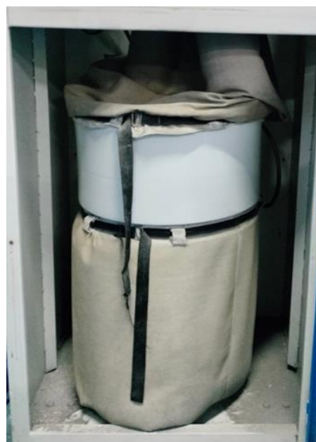
Hình 3. 15 Hình ảnh thiết bị xử lý bụi đi kèm máy mài, gọt
